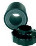
Os adaptadores redutores são utilizados para acomodar diâmetros de tubos mais pequenos em entradas de kits de isolamento maiores. O adaptador redutor fica pressionado dentro do kit de isolamento, e a transição entre o adaptador e o tubo pré-isolado é selado com o tampão termoretrátil, incluído no conjunto.
