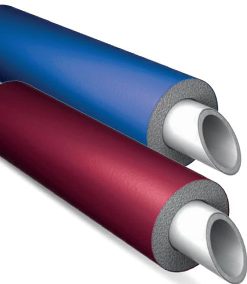
Para minimizar perdas térmicas também poderão ser utilizadas tubagens Vissen já isoladas. O isolamento destes poderá ser vermelho (água quente) ou azul (água fria) para facilitar a identificação da rede onde será instalado. É importante que os tubos e acessórios a utilizar sejam da mesma marca de forma a garantir a homogeneidade da rede e o seu funcionamento. A referência preconizada é do tipo Vissen.
